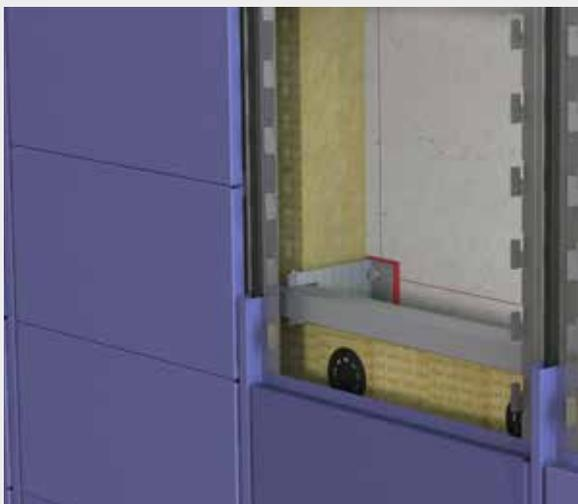
Mehrlagige Unterkonstruktion: System horizontal/vertikal
